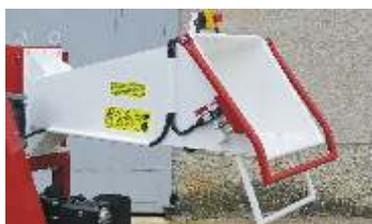
Alle URBAN-Holzhackler verfügen über einen ausreichend langen Trichter, der mit einem Sicherheitsbügel versehen ist. Die Trichter sind horizontal angebracht, um das Einbringen langer Äste zu erleichtern.
