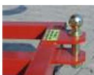
An den Holzhacker können weitere Anhänger über einen Metallbolzen oder eine Kugelkopf-kupplung (ISO 50) befestigt werden.
