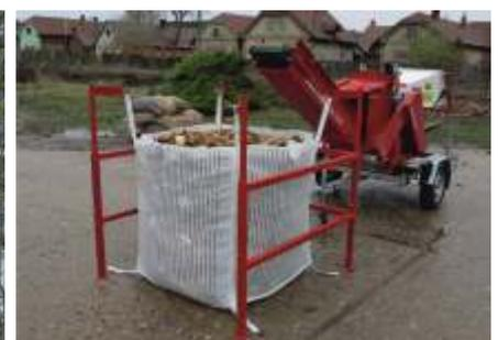
Die **Doppelvorrichtung** zum Abfüllen in Raschelsäcke mit Stützbein kann an das Ende aller Förderbänder montiert werden. Der Anbau ist mittels 4 Schrauben schnell erledigt.
