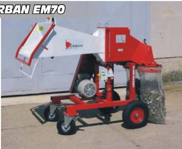
Der EM70 unterscheidet sich vom Typ SM70 nur durch den Motortyp – er wird durch einen 3-phasigen 5,5 kW-Elektromotor angetrieben. Das Fahrgestell des Holzhackers verfügt über 4 Räder für den Handtransport (2 feste und 2 lenkbare mit Bremsen).
