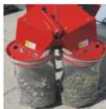
An der Doppelvorrichtung zum Abfüllen in Raschelsäcke befindet sich ein Hebel, um den Wechsel von einem zum anderen Sack zu ermöglichen. Während der eine Sack gefüllt wird, kann der volle Sack auf der anderen Seite ersetzt werden. Bei kontinuierlicher Beladung von Zweigen ist es möglich, den Beutel bereits nach 20 Sekunden zu füllen.
